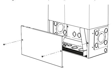
Figure 2-10 Conduit Box installation
